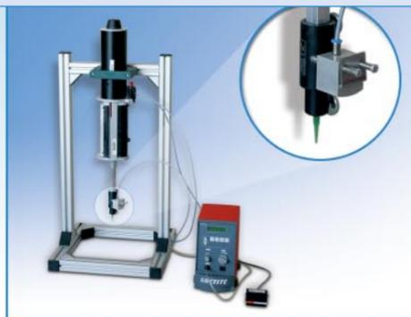
Sistema ad applicatore pneumatico per doppia cartuccia. Garantisce il corretto rapporto di miscelazione per un'applicazione senza sprechi.
